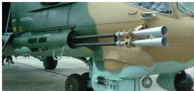
11. ábra A GS-2-30 gépágyú
