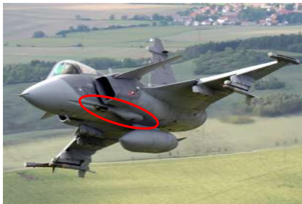
6. ábra Mauser BK-27 gépágyú elhelyezkedése a JAS-39-en
