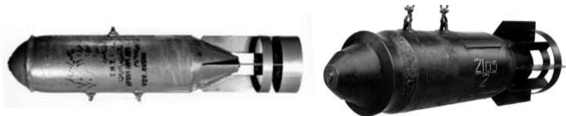
12. ábra A FAB-250M79 és a FAB-500M54 légibombák
