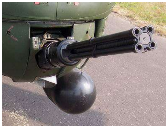
10. ábra A JakB-12,7 géppuska
