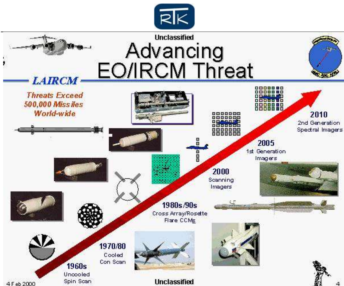
1. ábra Az infravörös önirányítású rakéták fejlődési iránya [3]
