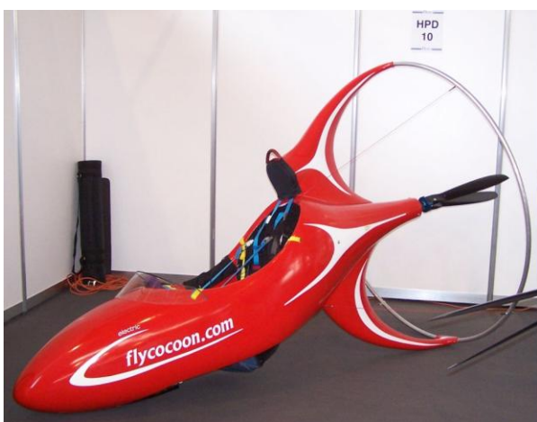
Elektromos hátmotoros kabin siklóernyőhöz
