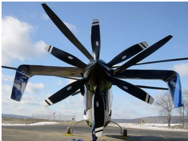
7. ábra. A Sikorsky X2 farok légcavarja [2]
