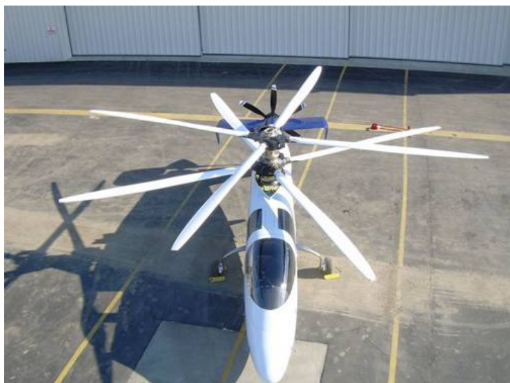
8. ábra. A Sikorsky X2 koaxiális elrendezésű forgószárnyai [3]
