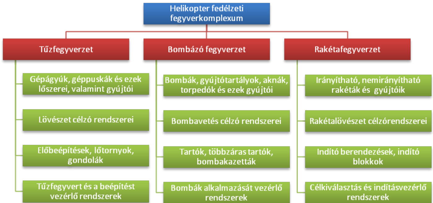
1. ábra A helikopter fedélzeti fegyverzet komplexum
