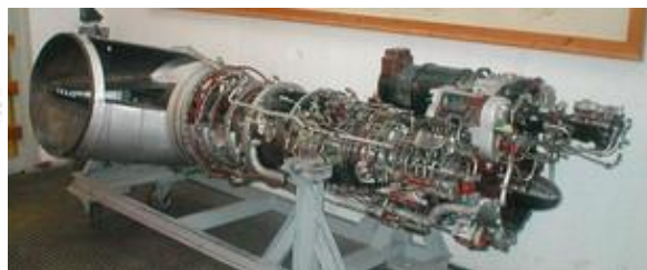
3. ábra. Az Izotov TV2-117A hajtómű volt az első orosz helikopterbe tervezett hajtómű
