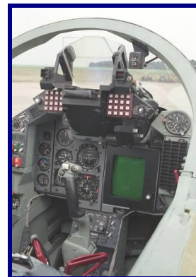
2-6. Az L-39MS repülőgépek kifejlesztése a korszerű Szovjet vadászgépekre való kiképzés érdekében történt. Nagyobb tolóerő-súly viszonytal és az L-39-nél nagyobb teljesítőképességgel rendelkeznek. Ezeken a gépeken fenti mellső elhelyezésű vezérlőpulttal rendelkező homloküveg kijelző, többfunkciós kijelző, rövid hatótávolságú rádió navigációs rendszer (RSzBN) és inerciális navigációs berendezés található.
