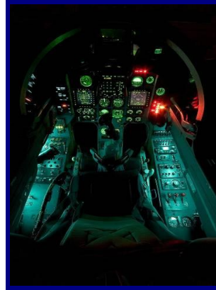
3-6. Az L-159 repülőgépvezető fülke a HUD, az MFD és a HOTAS rendszerekre épül.
