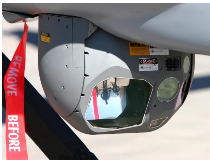
7. kép. Az RQ-1 „Predator” elektrooptikai felderítő eszközei
