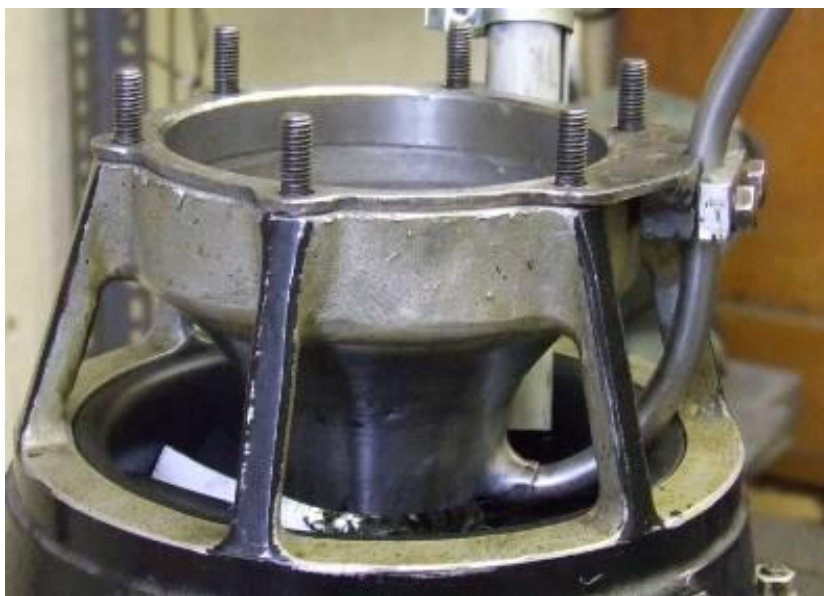
26. ábra. A fordulatszám-érzékelő elhelyezése az áramvonalazó kúpon belül
