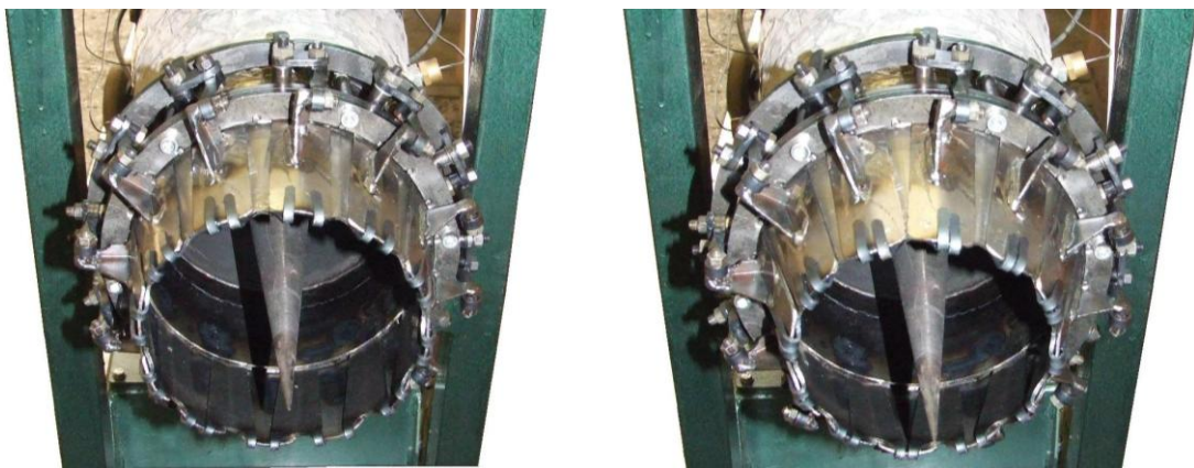
2. ábra. A GSF redőnyzet nyitott (bal) és csukott (jobb) állapotban
