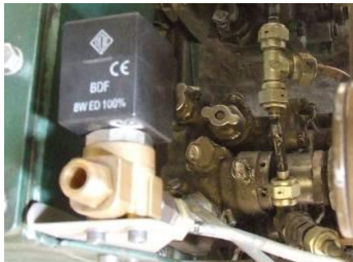
8. ábra. Az arányos szelep elhelyezése
