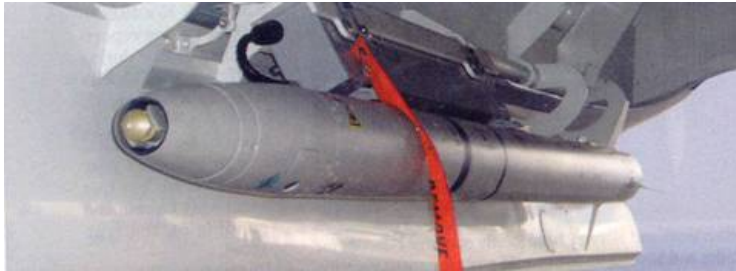
Az MBDA ASRAAM leképező, infravörös önirányítású rakéta mind belső elhelyezésű, mind pedig külső függesztésű változatban beintegrálásra kerül az F-35 repülőgép fedélzeti fegyverrendszerébe.
