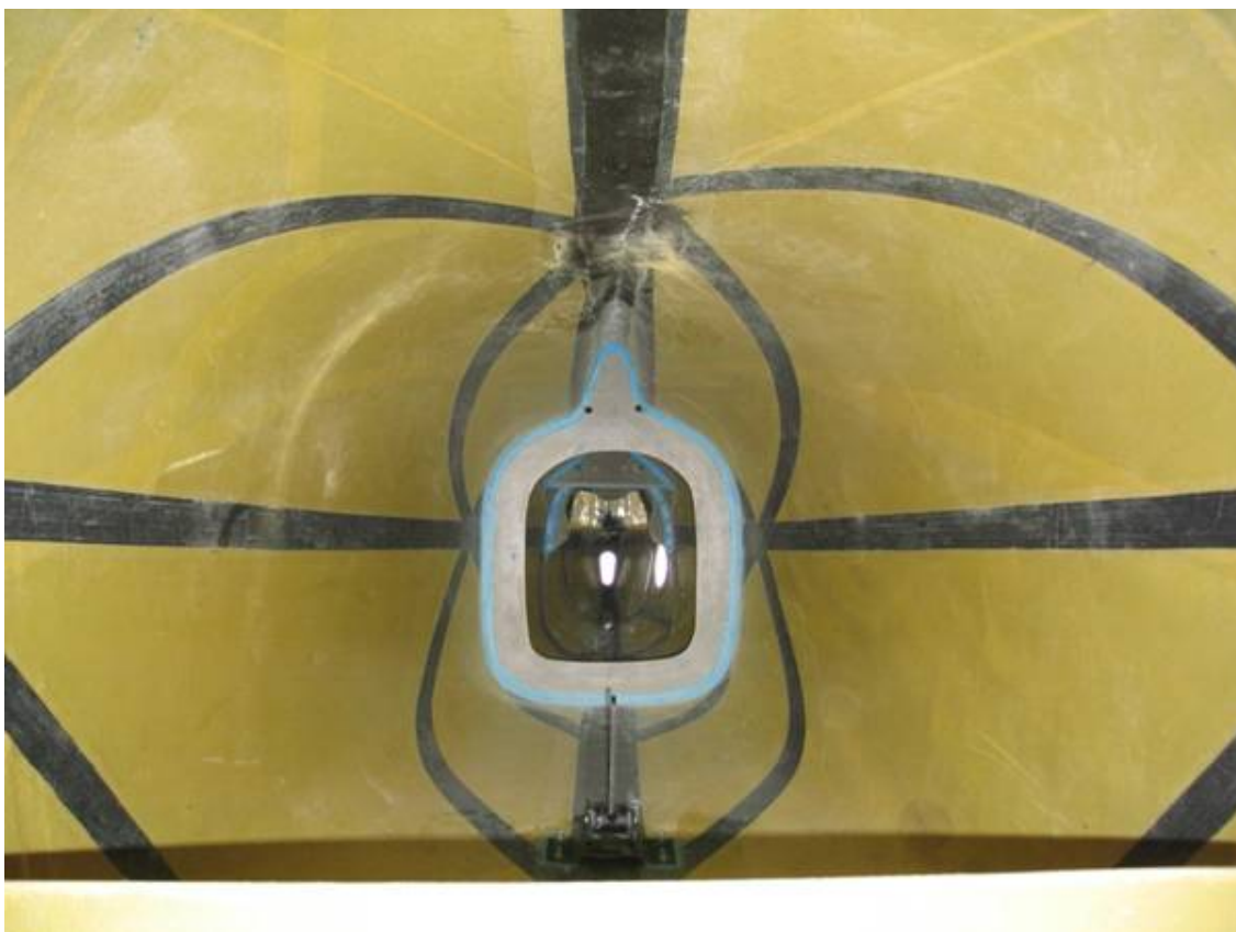
5. ábra Héjszerkezetű törzs belső kialakítása
