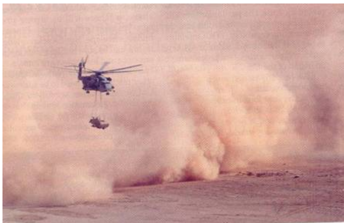
A haderónemek a Yuma (Ariz.) melletti por- és homoksvatagon végzik a lecsökkent látási körülmények közötti üzemeltetést biztosító megoldások értékelését. A képen egy Sikorsky CH-53E helikopter a forgószárnyával felvert homokkal "brownout" viszonyokat hoz létre.
