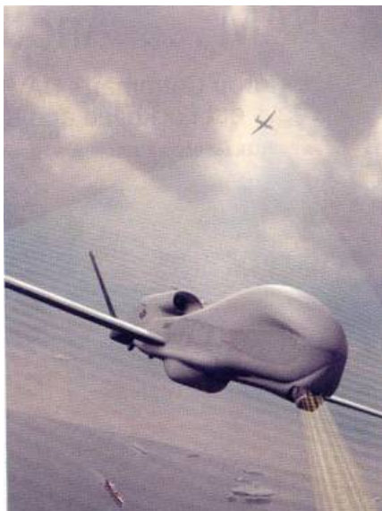
A BAMS UAV repülőeszköz 360o-os körforgást biztosító aktív elektronikus pásztázást alkalmazó antennarendszerrel (AESA) ellátott lokátora a törzs alatti radar dombán, a toronyra szerelt
