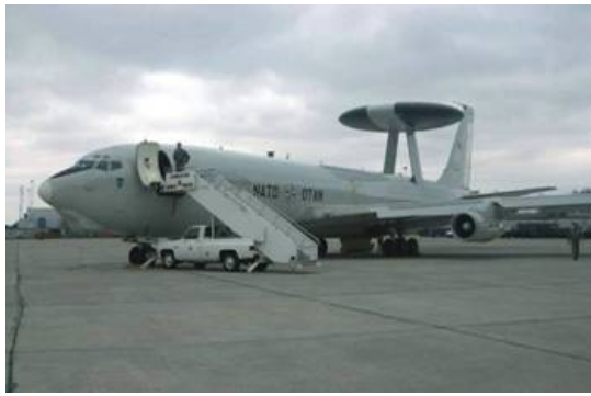
Az NMT program alapján módosított E-3A repülőgép egyedüli külső megkülönböztető jellemzőjét a forgó radardóm előtt elhelyezkedő kiegészítő műholdas távközlési (Satcom) antenna képezi.
