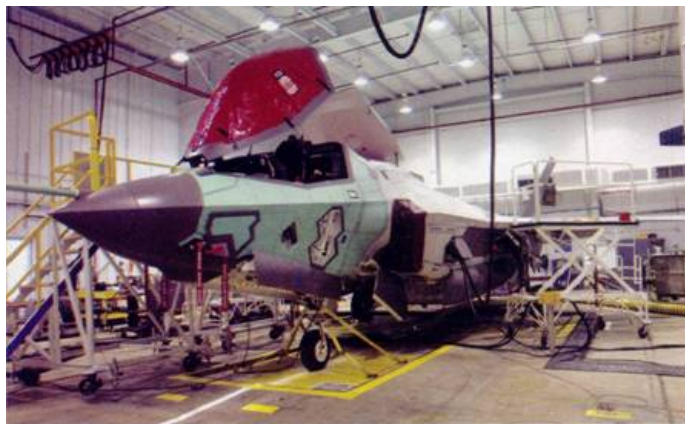
Az első F-35B Stovl változatú gyártási prototípus repülőgépen a sárkány- és hajtómű rendszerek ellenőrzését végzik a Lockheed Martin cég Forth Worth-ben lévő üzemegységében
