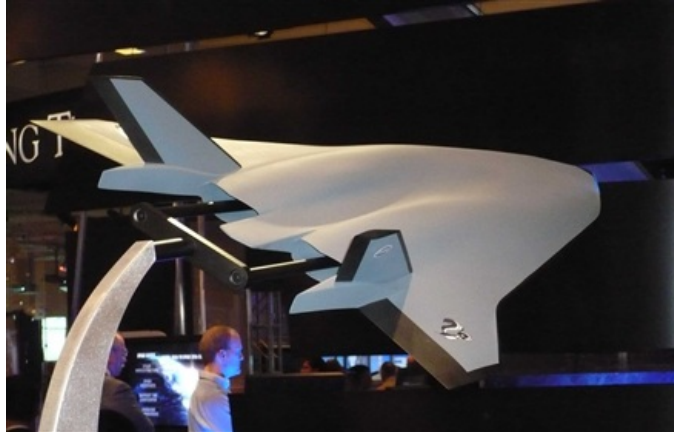
Az integrált „waverider” konfigurációjú Blackswift demonstrátor repülőeszköz méreteit tekintve hasonló lesz a Lockheed Martin cég 47 ft hosszúságú Have Blue lopakodó demonstrátorához
