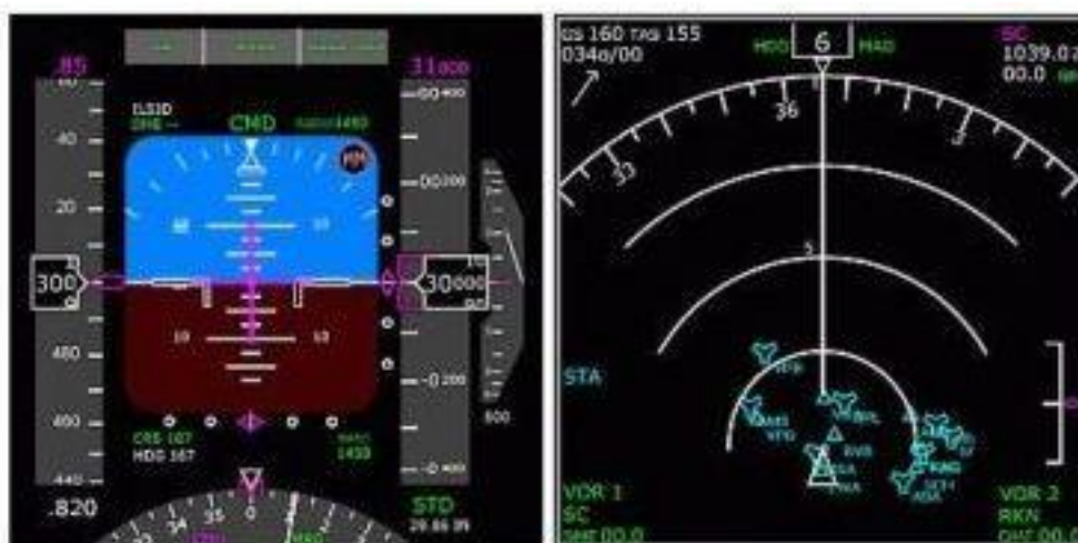
15. ábra. Boeing 737NG elsődleges repülési és navigációs display
