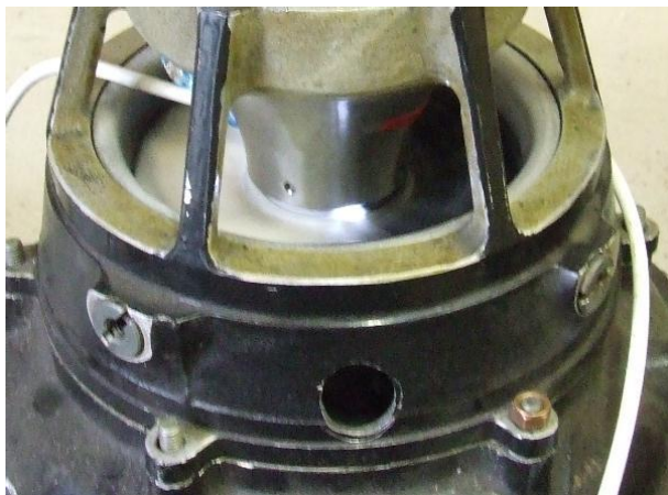
13. ábra. Az áramvonalazó kúp alatt látható a fordulatszám-érzékelő fényfoltja
