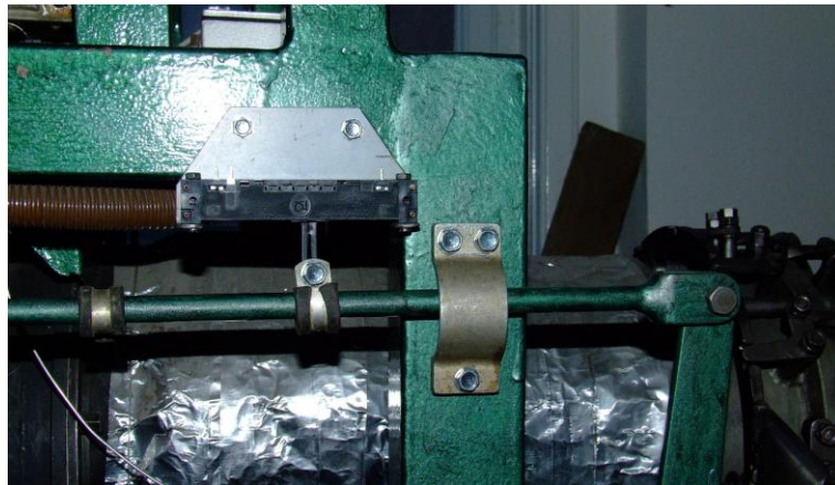
14. ábra. A fúvócső keresztmetszetét rögzítő toló potenciométer
