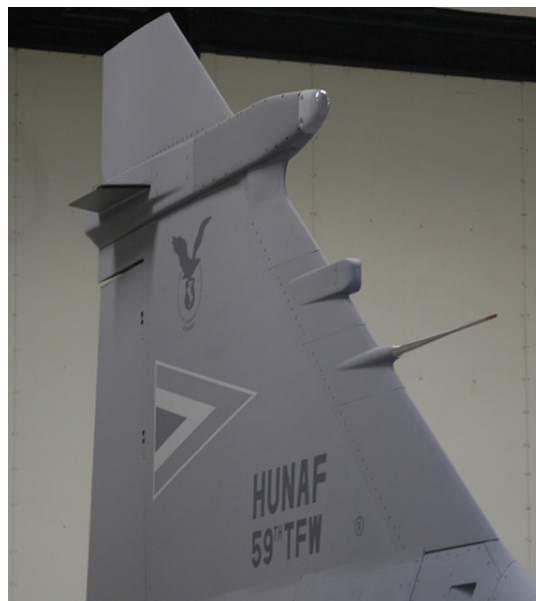
7. ábra Zavaróantenna-egység egy magyar Gripen függőleges vezérsíkján
