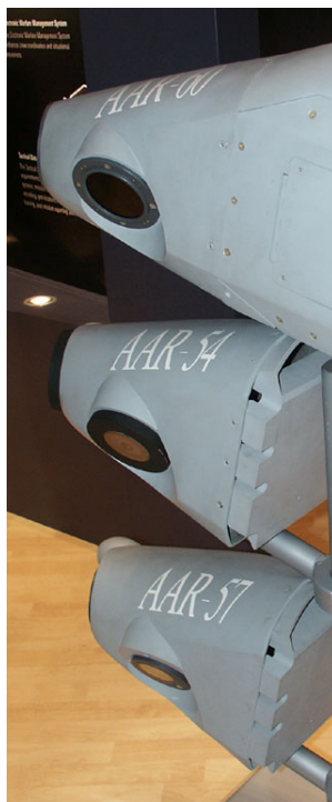
10. ábra F-16-os fegyverfelfüggesztő pilonjába építhető indításjelzők
