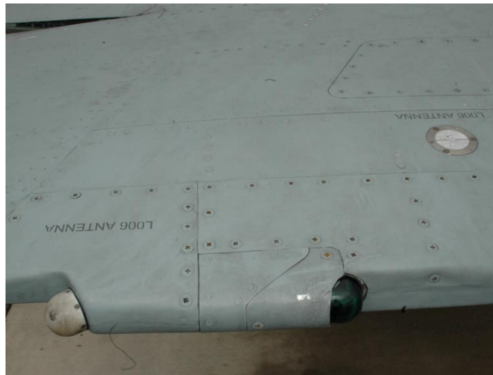
3. ábra A MiG-29 repülőgép L-006 besugárzásjelzőjének antennái a szárny törővégén
