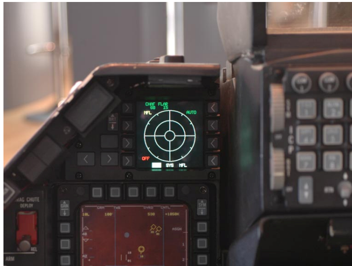
6. ábra A REH-rendszer információinak kijelzésére szolgáló képernyő egy F-16-os pilótafülkéjében
