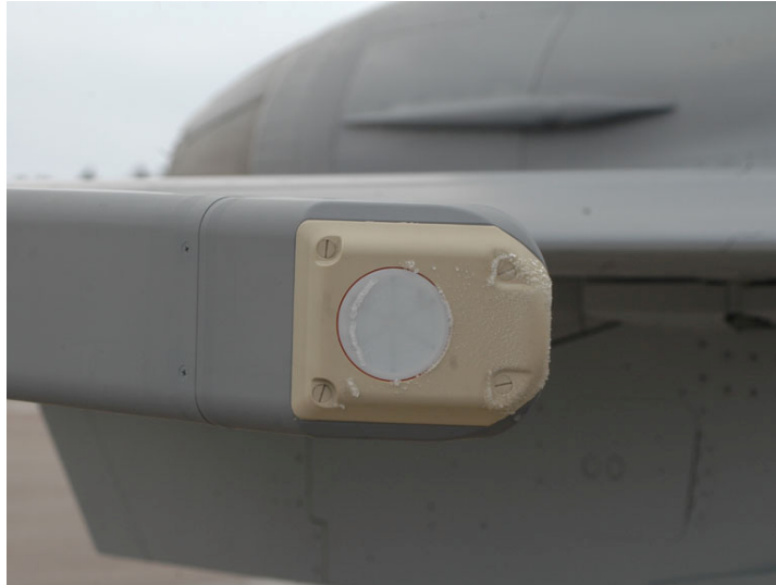
4. ábra Besugárzásjelző spirálantenna és antennaegység egy magyar Gripenen
