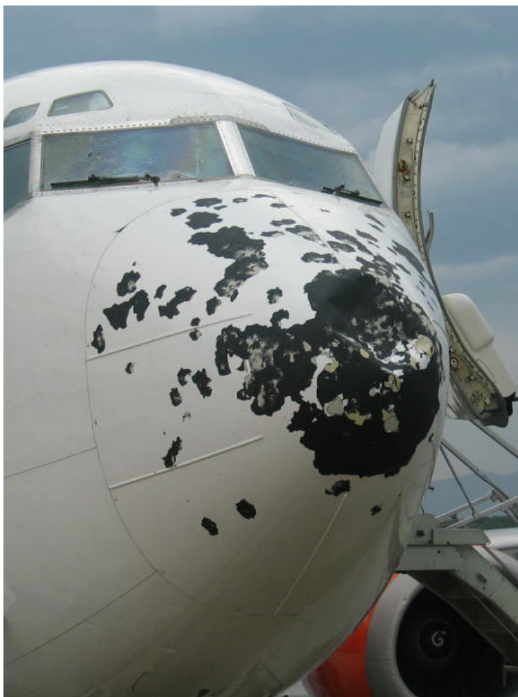
21. ábra Törzs orr-rész ütközés után ( http://flightlevel.20megsfree.com/ )
