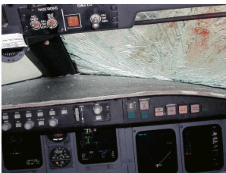
19. ábra Pulyka ütközés következménye a kabinban (WASHINGTON, 2002.) [6]
