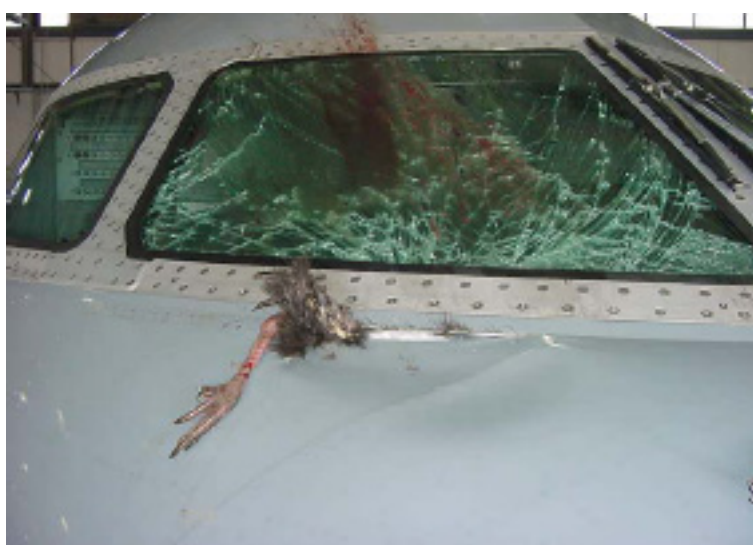
18. ábra Pulyka ütközés következménye a kabinon kívülről (WASHINGTON, 2002.) [6]
