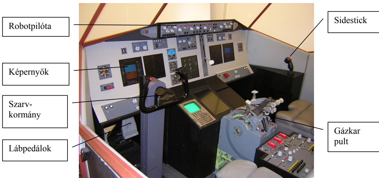
2. Ábra: A pilótafülke kialakítása
