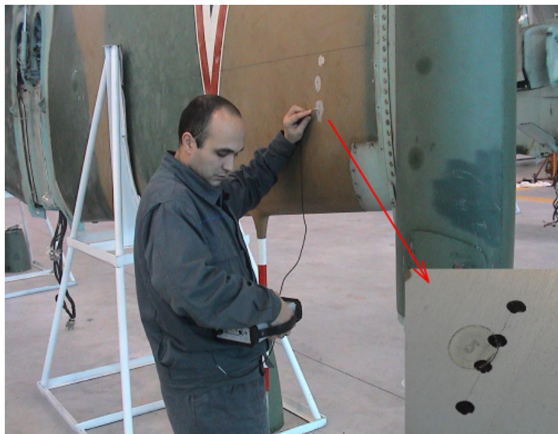
4. ábra. L-39 típusú repülőgép szárny vizsgálata
