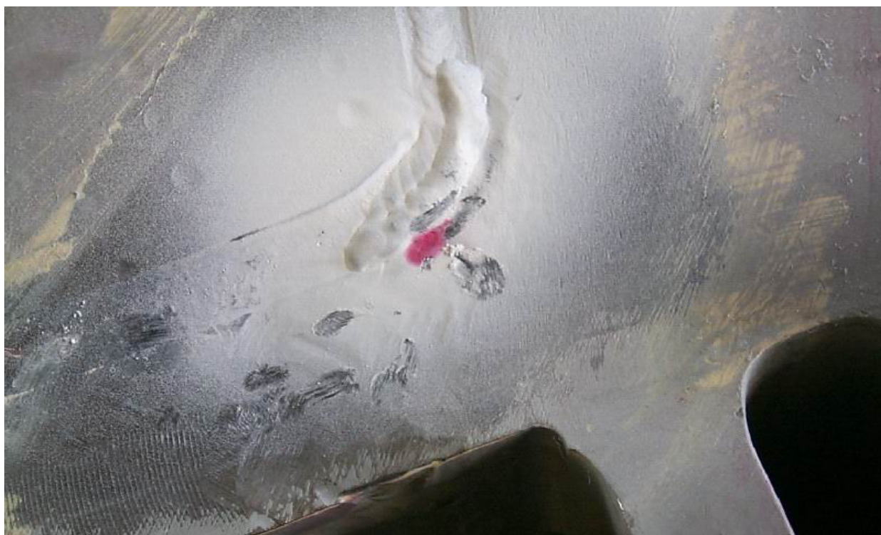
2. ábra. Repedés kimutatása MiG-29 típusú repülőgép törzstartályon
