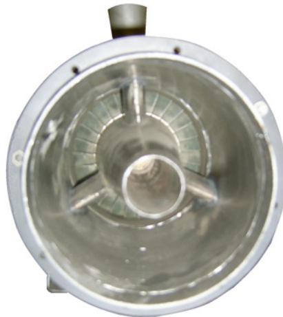
8. ábra: A fűvócső belseje a turbina futólapát koszorújával
