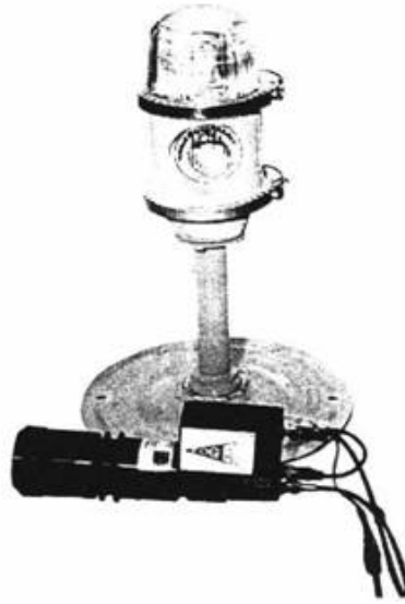
2. ábra. A ködszem érzékelő és fényforrása
