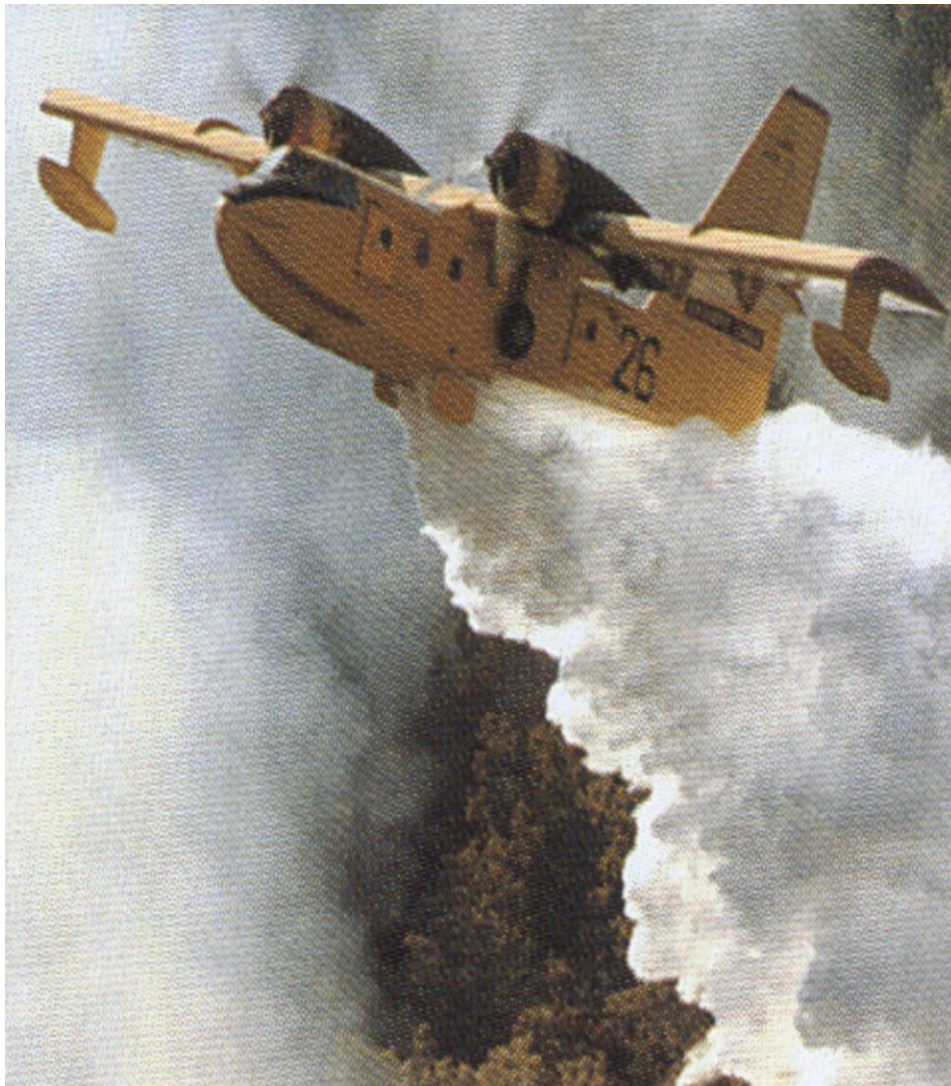
4. ábra. CL-215 (CANADAIR) kételtű szárazföldi és vízfelszíni alkalmazású tűzoltó-repülőgép. Forrás: A világ repülőgépei. (Mester kiadó, Budapest 2000-2005 – 8. csoport 48. kártya)
