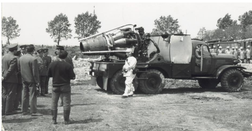
2. ábra. MIG-15 — szubszonikus sugárhajtású repülőgép — hajtóművével épült turbóreaktív oltógép
