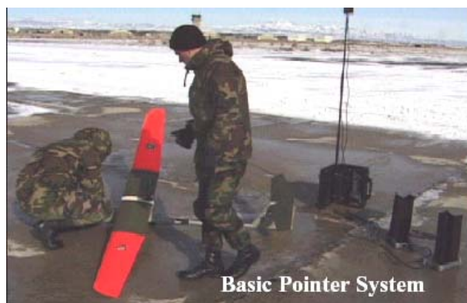
1. ábra. A POINTRE FQM–151A rendszer elemei [4]
