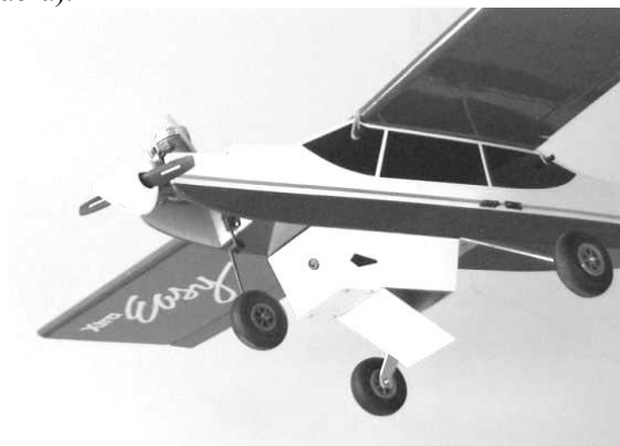
3. ábra. A micropilot EZUAV nevű, kisméretű szabadon repülő modellje videokamerás kivitelben
