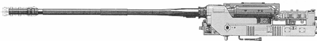
10. ábra. A Mauser BK27 27 mm-es gépágyú
