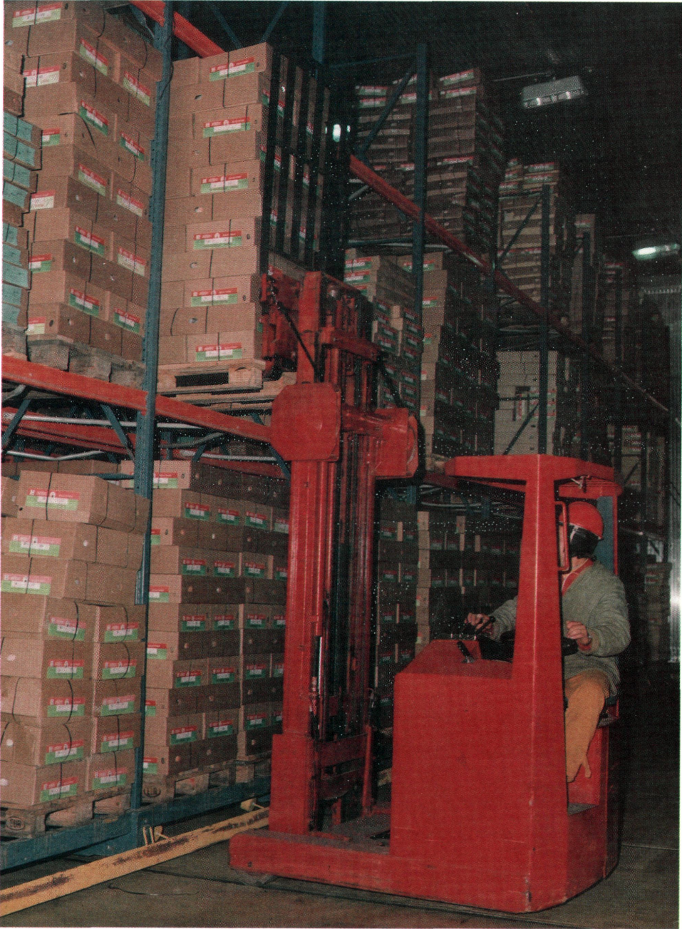
99. kép: A hűtőtároló tolóállványai és a rakodókocsi, 1984 Bild 99: Rollregale und Ladewagen des Kühllagers. 1984 Picture 99: Wheeled shelves and loading — vehicle of the cold-storage. 1984
