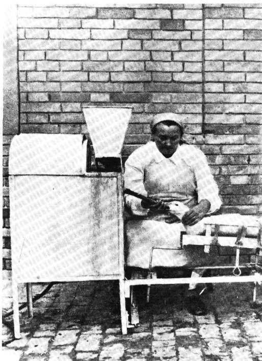
55. kép: Labádi-féle, villannyal hajtott tolócsigas tömőgép, 1956. (Első az ilyen rendszerű gépek között.)
