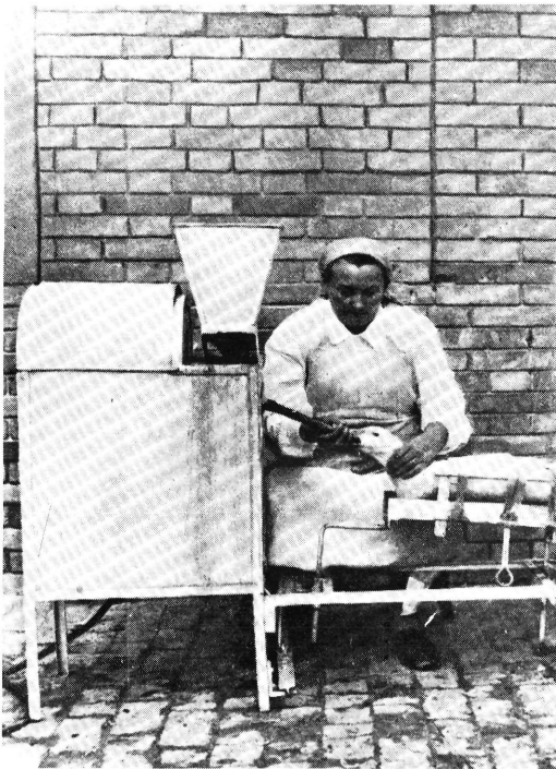
55. kép: Labádi-féle, villannyal hajtott tolócsigás tömőgép, 1956. (Első az ilyen rendszerű gépek között.)
