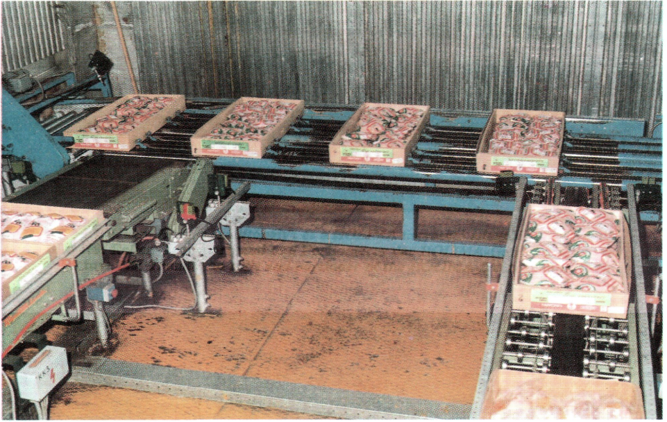
100. kép: Görgős szállítópálya és a HOLIMA fagyasztó adagolója, 1984 Bild 100: Rollen-Transportband und Portionierer der HOLIMA-Gefrieranlage. 1984 Picture 100: Trundle on rolls and portioner of the HOLIMA-freezing-unit. 1984
