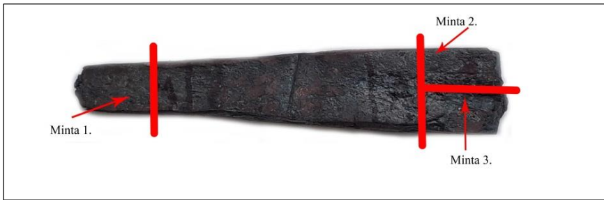
3. ábra. A kísérlet során kialakított próbatest, amelyből három minta került kimetszésre
