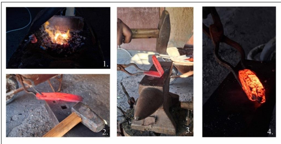
2. ábra. A próbakovácsolás során az első lépés az alapanyag hevítése és tömörítése (1.) volt, ezt a formázás és nyújtás követte (2.), majd a hajtás (3.), végül pedig a hajtást követő kovácshegesztés (4.). A teljes folyamatot összesen négyszer ismételtük meg.
