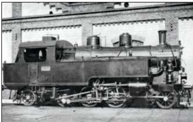
7. kép. MÁV 375. sorozatú, mellékvonali gőzmozdony (korábban TV. osztály) 27
