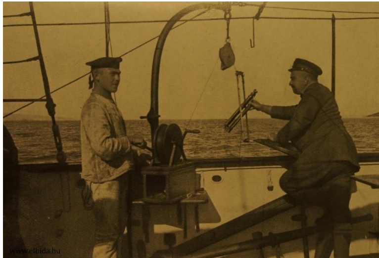
A tengervíz sótartalmának meghatározására Richard-palackkal vízmintát merítenek
