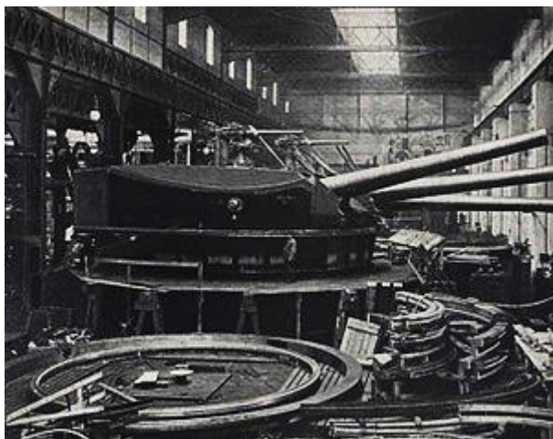
A pilseni Skoda gyárban készül a Viribus Unitis első háromlőveges lövegtornya
