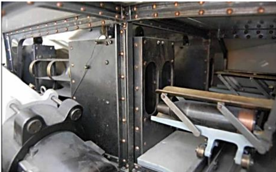
Egy Tegetthoff osztályú csatahajó lövegtornyának részlete a lőszerszállító kocsi 3060
