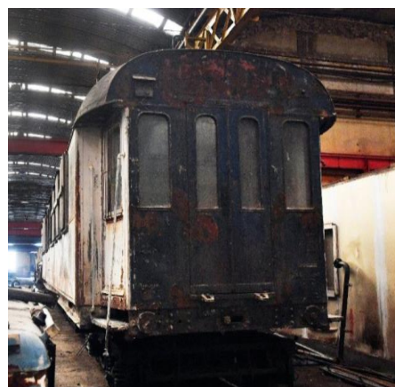
A Turán 9-es szállításra előkészítése. A vagon súlya 21 tonna.
