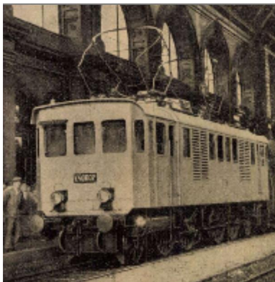
Az első Kandó-mozdony a Keleti-pályaudvaron. (MÁV V40-es sorozat, engedélyezett sebessége 100 km/óra.) Feltehetőleg a képen látható mozdony húzta a Turánt is. Erre a cikk megjelenéséből követ-
