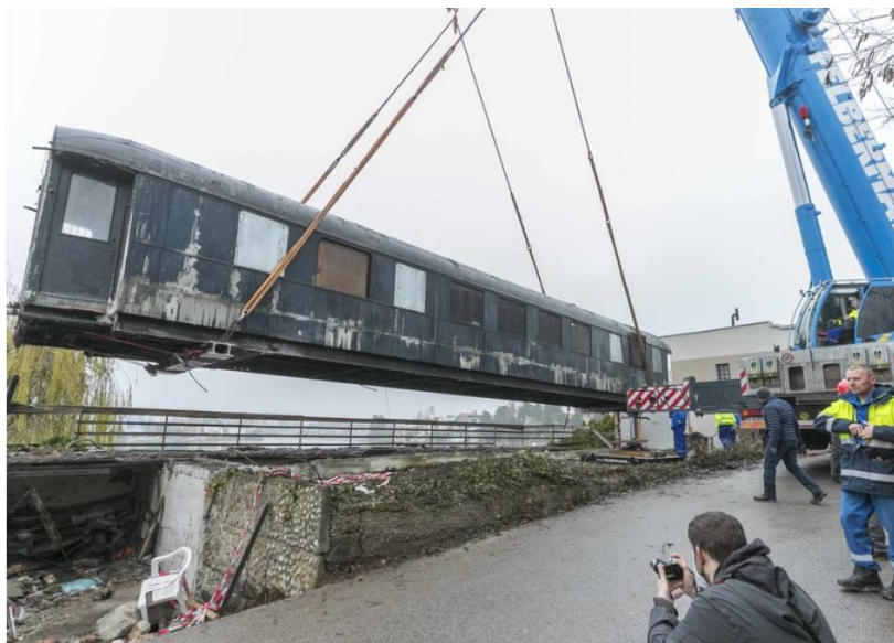
A Turán 9-es szállításra előkészítése. A vagon súlya 21 tonna.
