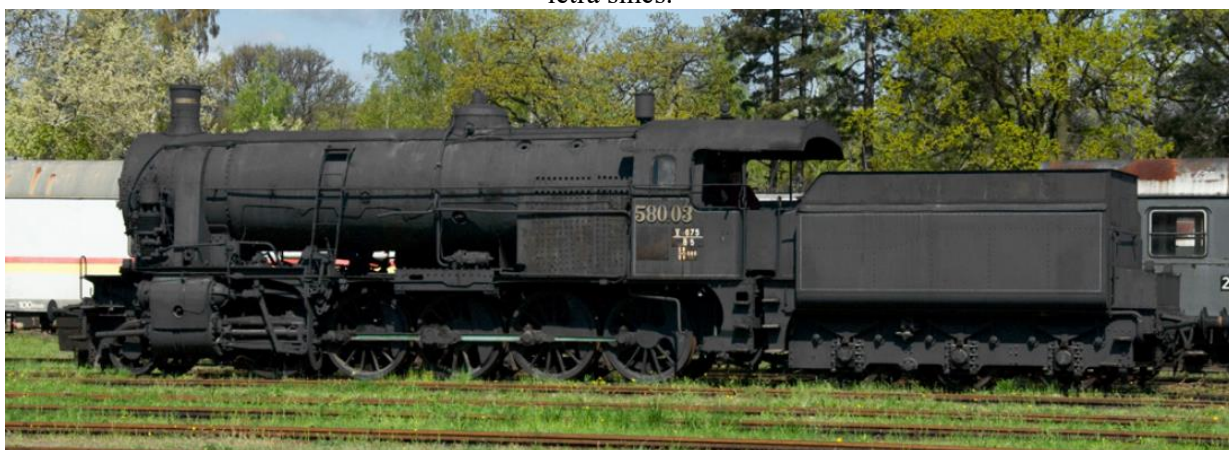
SB 580 (BBÖ 580.03 Strasshofban, ÖBB 258) hegyi pályamozdony 1912-1922 között 37 db épült. Engedélyezett sebessége 70 km/h.
