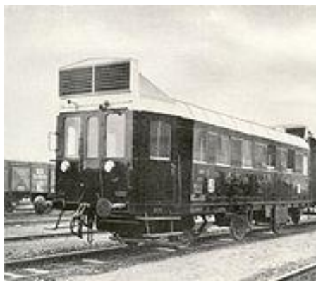
Egy BCmot mellékvonali motorkocsi. Az 1980-as évekig állt szolgálatban ez a típus. Ezt a típust és előzményét 1926-tól gyártották.
