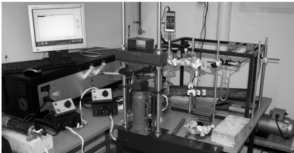
2. ábra • Az MTA CSFK Földtani és Geokémiai Intézetében működő lézerspektrométer és a hozzá csatolt vákuumrendszer
