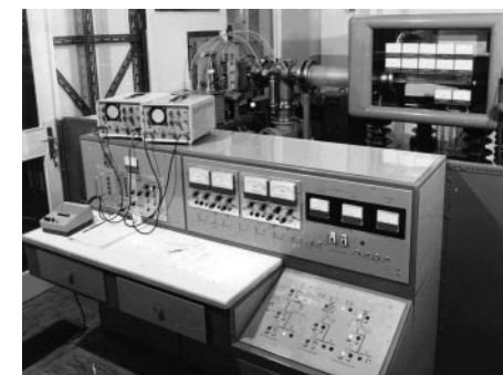
7. ábra • A KFKI-ban 1974-ben, az Ionimplantációs célprogram keretében, Pásztor Endre és munkatársai által tervezett és épített 150 kV-os ionimplanter, amelyet elsősorban MOS-eszközök, áramkörök előállítására szántunk, azaz nagyon pontosan kontrollált iondózisok belövése volt a cél
