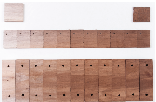
14. kép. Diófa lapokból különböző hőfokokon készített mintasor
