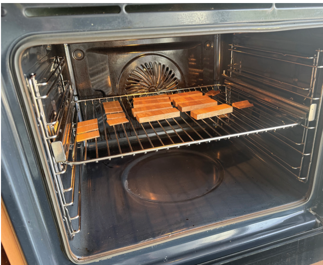
13. kép. A hiányzó diófurnér, svartni és párkánylécelemek pótlásának öregítése háztartási sütőben 160 °C-on
