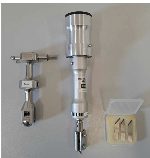
7. kép. A statikus kés, pengéi és a kis bígoló kerék
