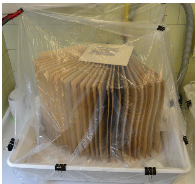
13. kép. Az albumtest illóolajos fertőtlenítése
