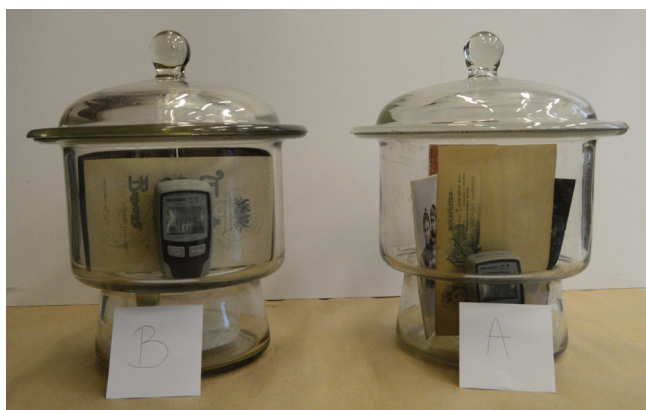
11. kép. Fényképek fertőtlenítése illóolajos párologtatással exsikkátorban
