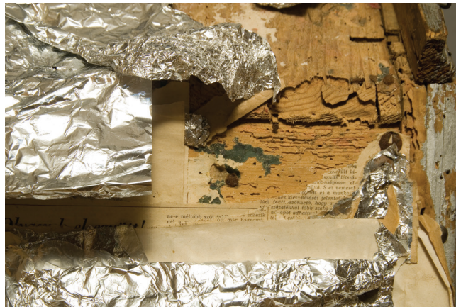
36. kép. A betlehem egyik oldalfalának részlete. A faanyag erősen károsodott, a borítópapírokat ragasztószalaggal vagy rajzszőgekkel rögzítették
