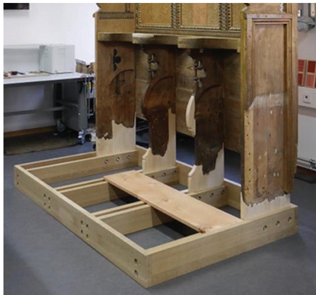
37. kép. Fakiegészítések a háromülékes stallumon és a rekonstruált pódium szétbontható szerkezete felületkezelés előtt
