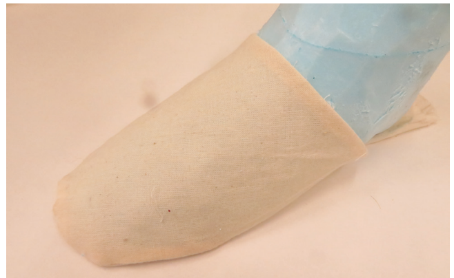
17. kép. A polisztirol forma kialakítása
