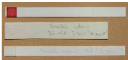
9. kép. Vas-ion teszt eredményei kezelés előtt és után (Apor-kódex, 33. folio).
