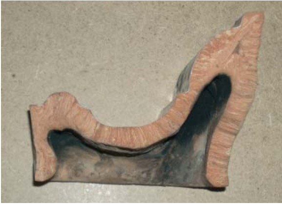
34-36. kép. A csempe anyagának rétegződése.
