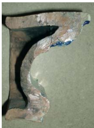
40. kép. Zsengélés előtt méretre vágott párkányelem.
