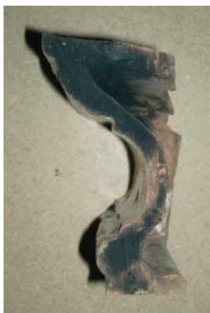
41. kép. Zsengélés és mázazás után kettévágott párkányelem.
