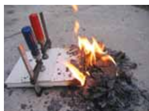
13. a-b. kép. A tesztlapok égetése és egy tesztlap az eredetihez hasonlóan elszenesedett széle.
