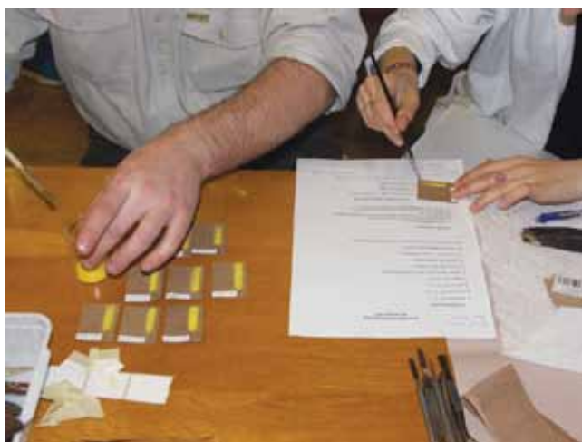
1. kép. Egyszerű kísérlet porló pigmentek megkötésére.
