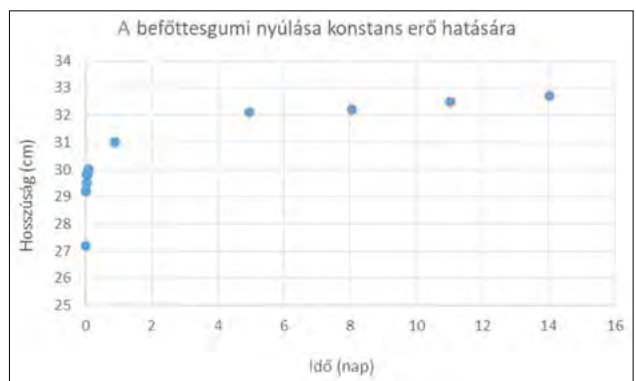
3. ábra. A befőttesgumi megnyúlása 2 N állandó erő hatására az idő függvényében
